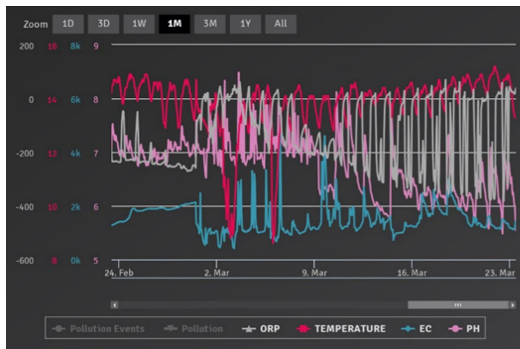
Grafico dei parametri misurati in continuo in uno dei sei punti monitorati della rete fognaria di Palazzolo sull'Oglio: conducibilità, PH, Redox e temperatura
