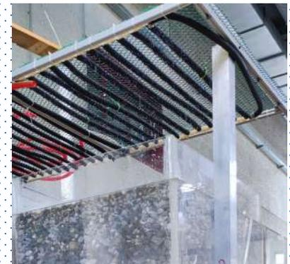
Dettaglio simulatore di pioggia del test-bed a Bologna
